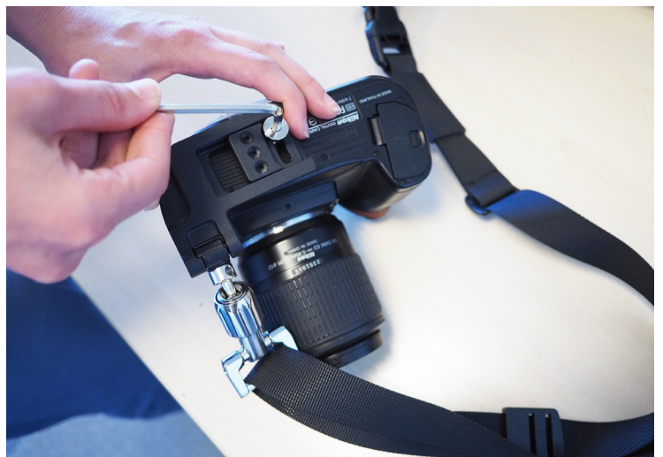
9) Bevestigd de plaat onder de camera met de 6-kantige sleutel (of een muntje).
